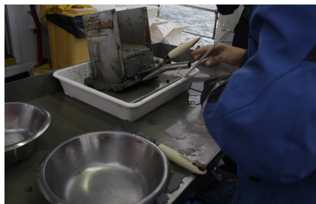
Figure 6: (côté à gauche) Navire océanographique Astrea utilisé pour les mesures de contamination; (en bas à gauche) collecte de sédiments par le carottier sur le fond marin près de l'île de Palmaria; (en bas à droite) extraction d'échantillons du carottier [Photos: Absolut, Copyright: CNR]
