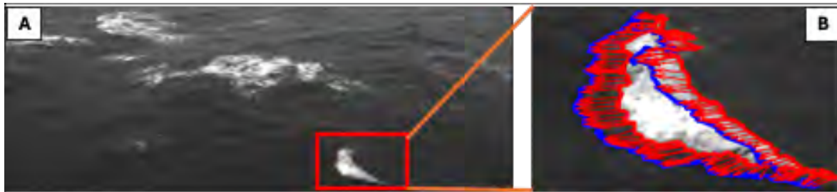
Figura 7 | Il pannello A mostra la superficie del mare con i frangenti riprese dalla piattaforma "Aqua Alta". Il pannello B mostra un primo piano di un frangente che si sta rompendo attivamente, tracciata individualmente. Le frecce rappresentano il movimento del whitecap calcolato con la tecnica di elaborazione delle immagini a flusso ottico.
