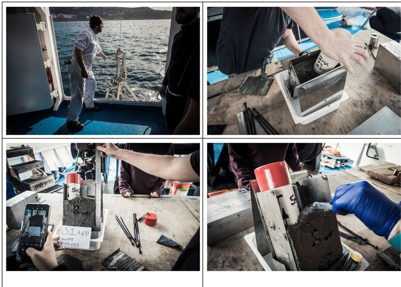
**Figura 7** – Fasi di campionamento sedimenti su Box Corer: recupero Box Corer, sub-campionamento con carota per analisi XRF, descrizione e catalogazione campione, prelievo per analisi microbiologiche.
