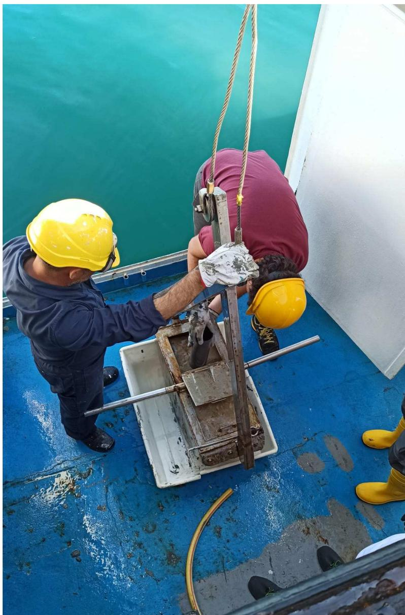
Fig. 7: Operazione di sub-campionamento con tubo in PVC
