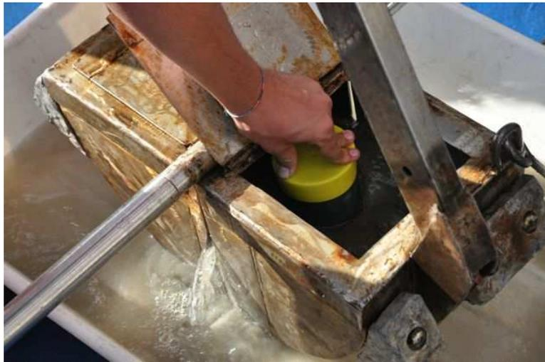
Fig. 4: Raccolta del sub-campione dalla benna da 65 litri modello Van Veen
