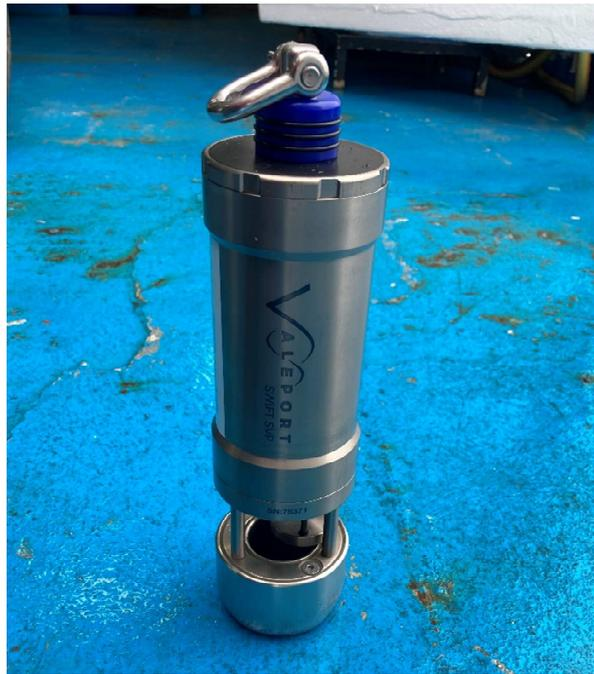
Fig. 2: Sonda multiparametrica Valeport SWiFT SVP
