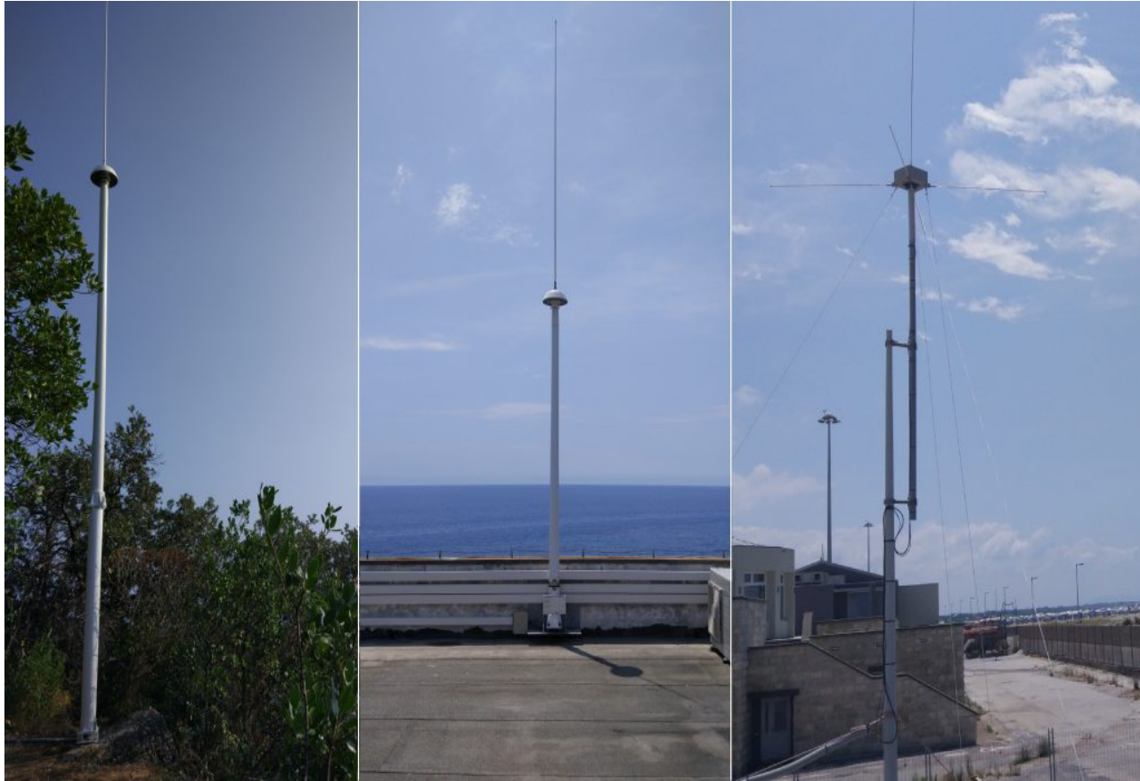
Figura 2: Da sinistra a destra, antenne radar HF delle stazioni acquistate (Isola del Tino), rinnovate (Portofino), o installate (Viareggio) grazie al progetto IMPACT [Foto: Mantovani C., CNR]
