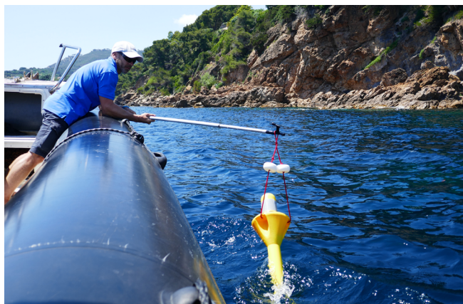
Figura 3: (in alto a sinistra) Recupero e rilascio (in alto a destra) di due dei tipi di drifter utilizzati nel progetto [Foto: Ourmières Y., Università di Tolone]; (a lato a destra) esempio di traiettorie dei drifter biodegradabili rilasciati a Maggio 2019 nell'esperimento a largo di La Spezia [Immagine: Berta M., CNR]
