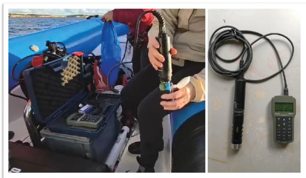
Figura 9. A sinistra, un'immagine del campionamento dell'acqua di fondo in una delle stazioni della campagna. A destra, la sonda multiparametrica HANNA HI98494 utilizzata per i campionamenti.
