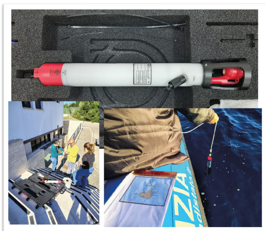
Figura 10. In alto, la sonda CTD RBR concerto 3 utilizzata per acquisire i parametri chimico-fisici della colonna d'acqua durante la campagna Giapeto2025. A sinistra, la fase di preparazione della sonda. A destra, la fase di immersione della sonda dall'imbarcazione della Polizia.
