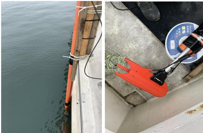
**Figura 10.** Particolari dell’installazione a palo dello strumento Side-scan sonar - StarFish Systems, installato sulla murata della M/N Alessandro 2, 19 dicembre 2024.
